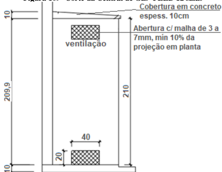
Figura 109- Corte da Central de Gás- PEED 12 salas
