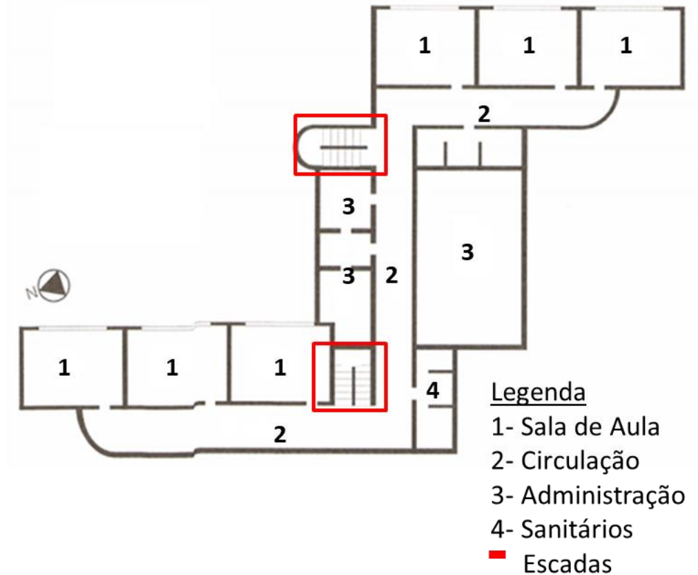
Figura 12- Planta do primeiro pavimento do Grupo Escolar Visconde Congonhas do Campo
