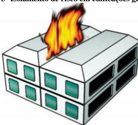
Figura 73- Isolamento de risco em edificações geminadas
