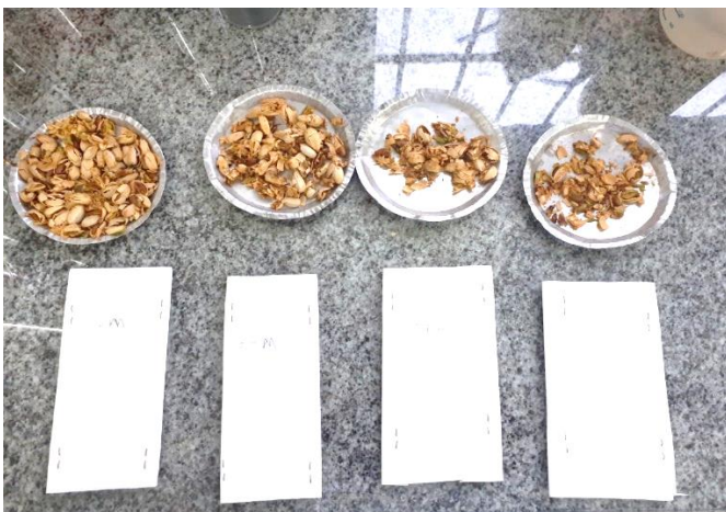
Figura 10- Extração por solvente das sementes de Nim: a) Sementes secas e papeis de filtro utilizados para a extração; b) Balões com solvente e óleo de Nim durante processo de extração.
