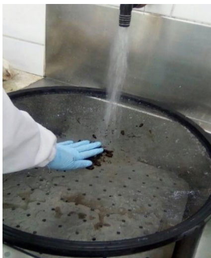
Figura 7- a) Peneira utilizada para realizar o despulpamento em água corrente dos frutos de Nim; b) Sementes após lavadas e despulpadas.
