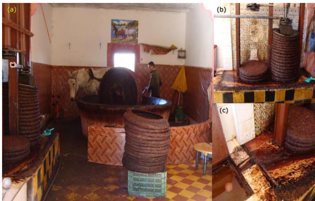
Figura 4- Processo de extração de óleo da semente de oliva em Marrocos no ano de 2011: a) Moagem com roda de pedra sendo movida por tração animal; b) filtros feitos da palha de tamareira; c) Escoamento do óleo depois de filtrado.
