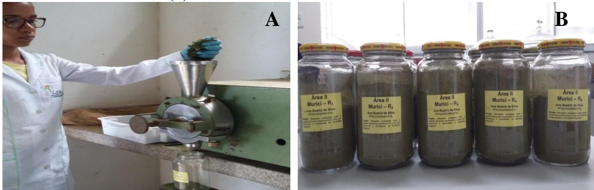
Figura 8 - Trituração das amostras em moinho de facas com peneira de 1 mm (A) e armazenamento das Amostras Secas ao Ar (ASA) em frascos previamente identificados (B).
