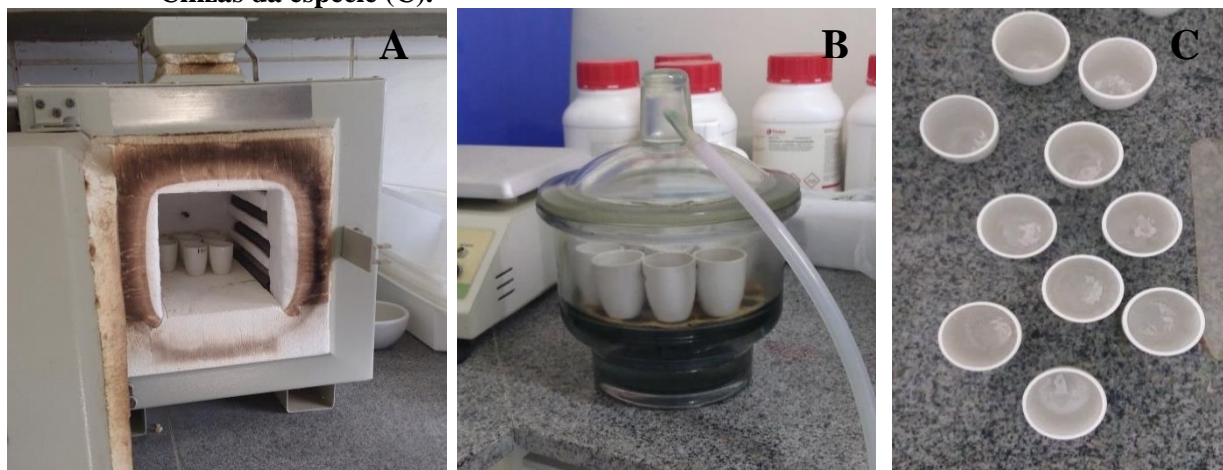
Figura 11 - Mufla com as Amostras Secas ao Ar (ASA) da espécie Byrsonima gardneriana A Juss (A), Amostras em dessecador após ser retirada da mufla (B) e Matéria Mineral ou Cinzas da espécie (C).
