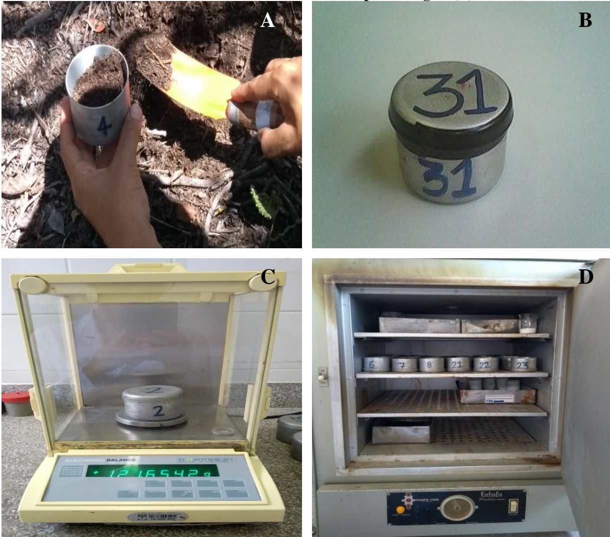
Figura 21 - Coleta de amostras de solo para determinação do conteúdo de água do solo (A), lata vedada com fita isolante (B), pesagem das latas com amostra de solo (C) e latas contendo material de solo inseridas em estufa para secagem (D).
