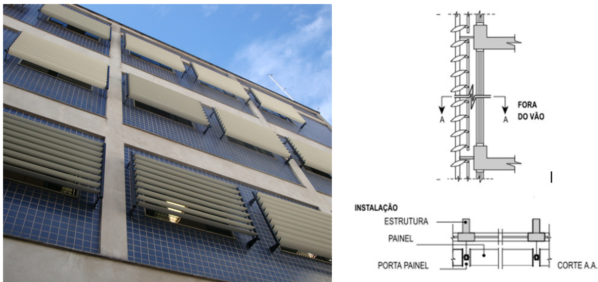
Figura 36 – Foto e desenho esquemático do modelo de brise móvel sugerido como MCE para as suítes principais e suítes opcionais do edifício Índico
