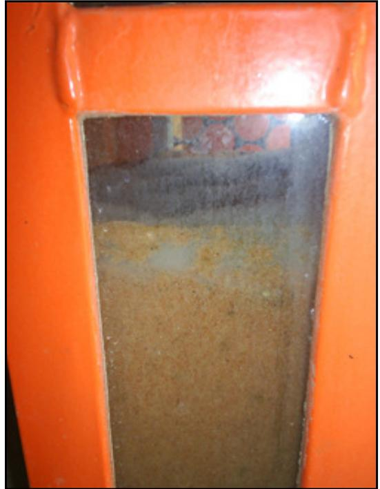
**Figura 43 - Exemplos do topo leito filtrante (areia) do filtro descendente ao final de um dos experimentos.**
