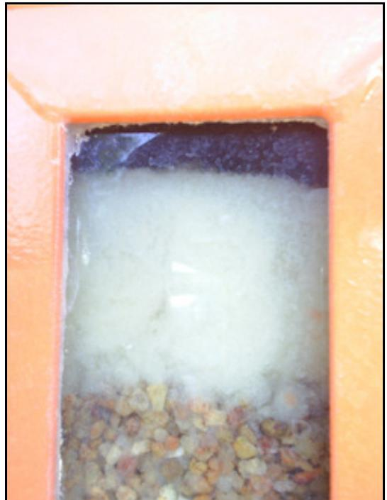
**Figura 42 - Exemplos do leito filtrante de Pedregulho saturado com os flocos do caulim coagulado, ao final de um dos experimentos.**
