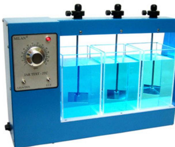
**Figura 16 – Equipamento de *Jar-Test* utilizado nos ensaios preliminares.**
