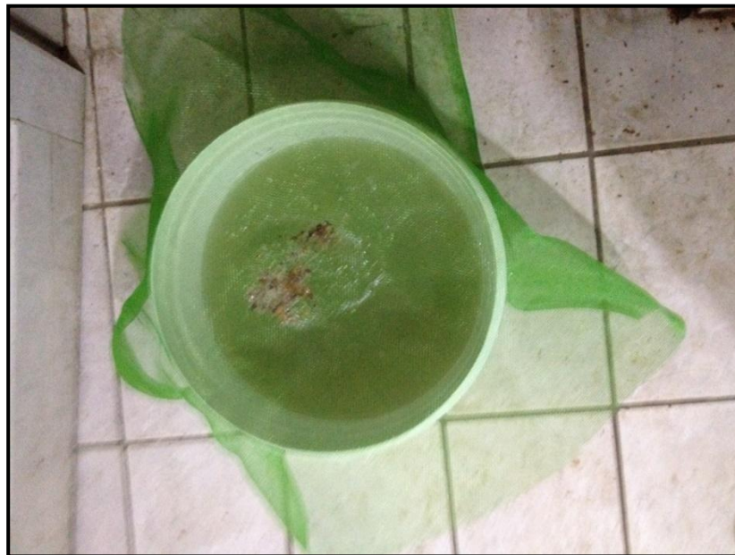
Figura 8 – Tela com malha de 1,25 mm x 1,25 mm utilizada para a retenção de sólidos grosseiros.
