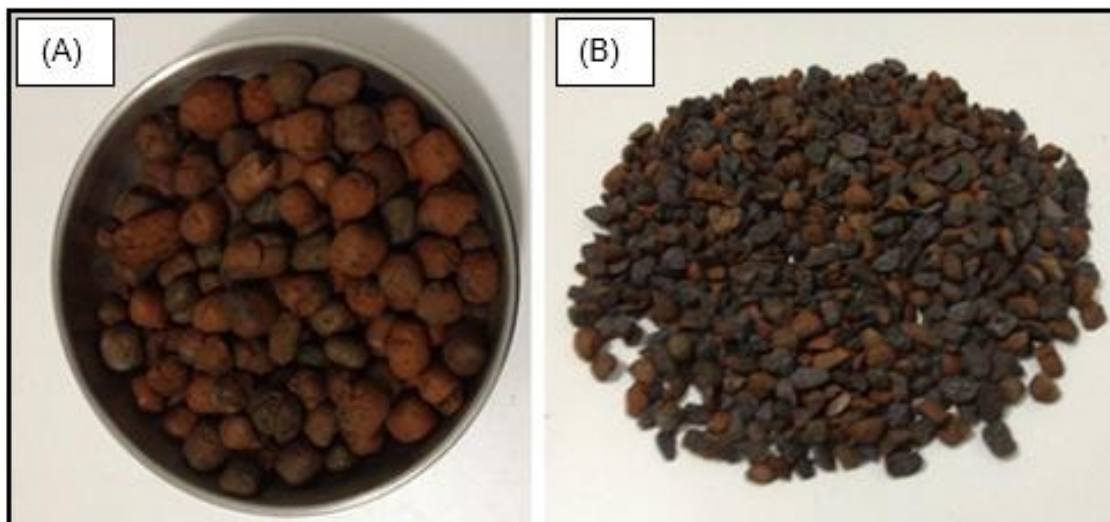
Figura 6 – Partículas de argila expandida utilizadas como suporte para aderência das populações microbianas, sem tratamento (A) e com tratamento (B).
