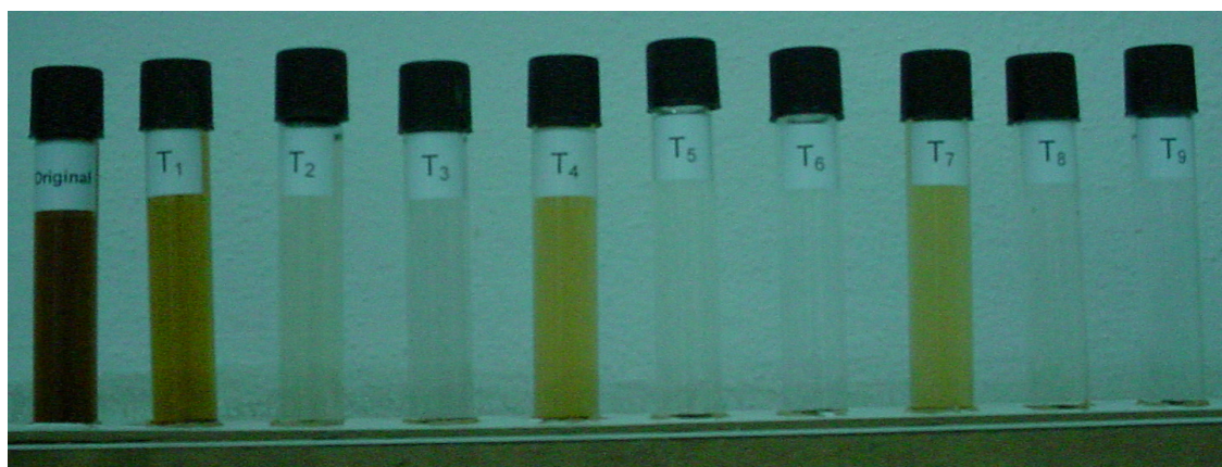
Figura 5.16 – Remoção de cor do chorume pelos processos de acidificação (pH =3), coagulação e adsorção em carvão ativado, aplicados de forma combinada.
