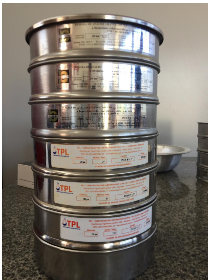
Figura 2 - Peneiras utilizadas no ensaio
