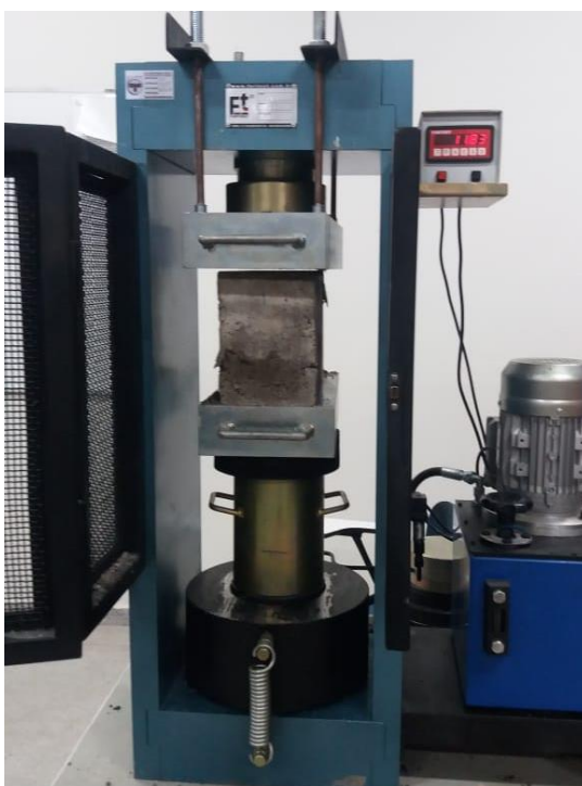
Figura 10 - Ensaio de resistência à compressão
