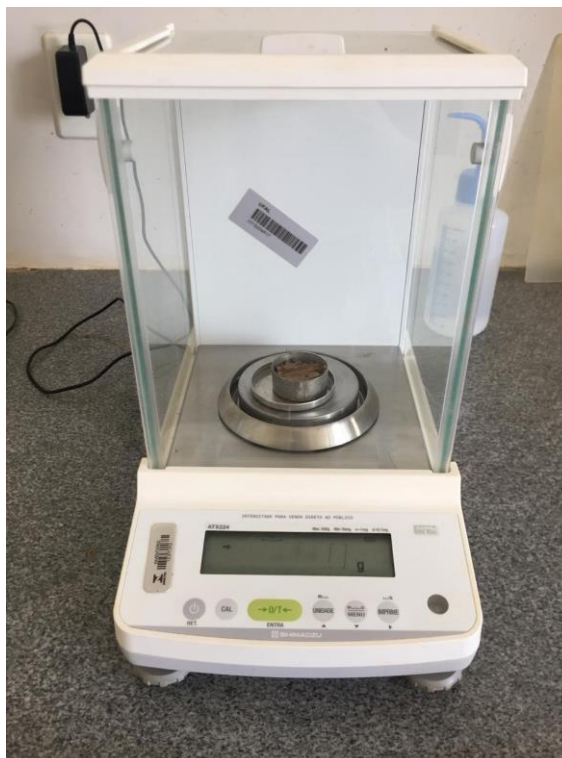
Figura 6 - Pesagem de solo para ensaio de limite de liquidez
