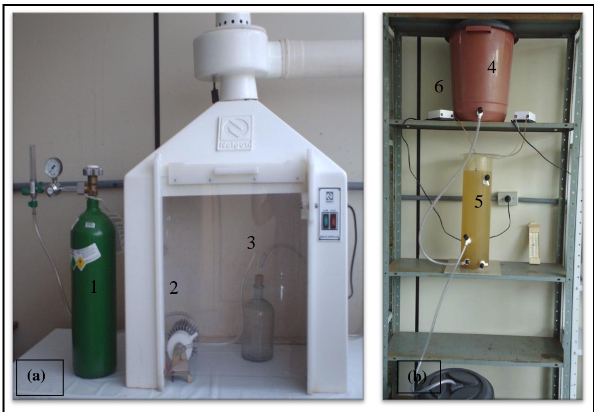
Figura 5 - Instalação experimental. (a) sistema de ozonização, (b) sistema biológico
