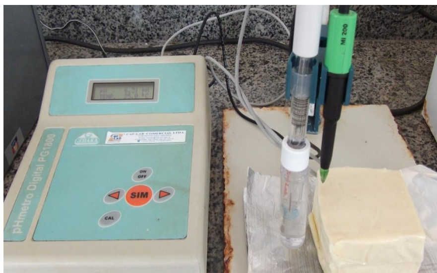
Figura 05 – Análise de pH (pHmetro digital e eletrodo específico para queijos)
