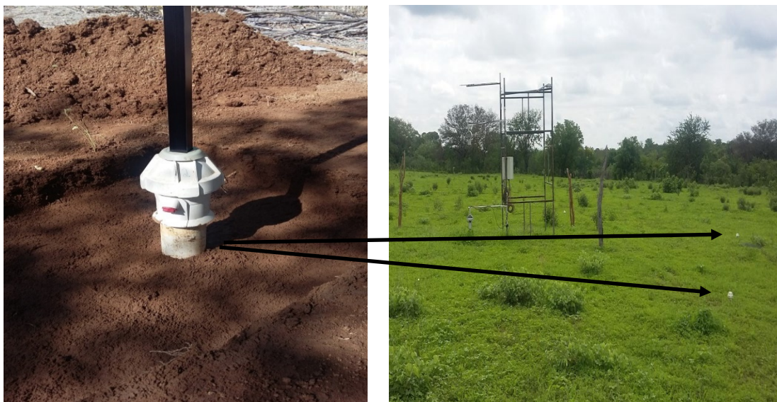
Figura 7. (A) Sonda capacitiva (B) Sonda capacitiva instalada na Área Desmatada.
