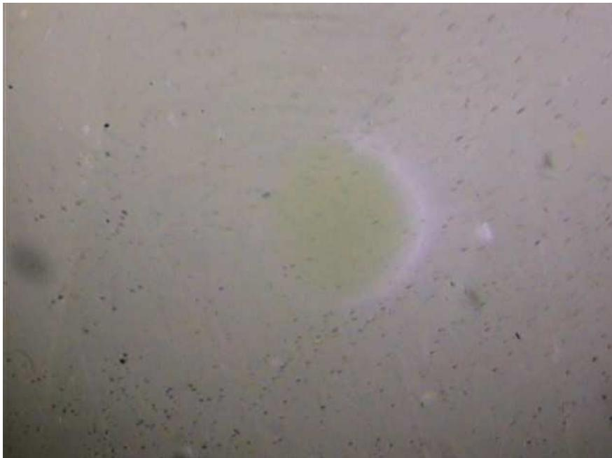
Figura 3.9 – Esmalte Bovino Hidratado irradiado (1W, 5s).
