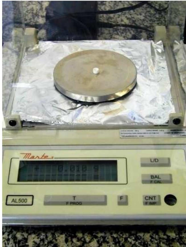
Figura 3.2 – Balança analítica de precisão (Marte®)
