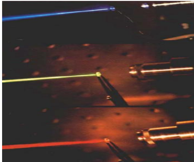
Figura 3 - Imagem do processo de geração de segundo harmônico em um cristal.
