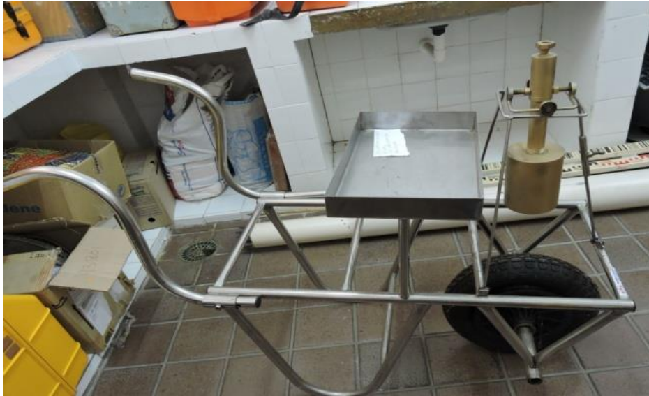
Figura 10 – Detalhe lateral do veículo transportador da antena GNSS. Fonte: Autora, 2017.
