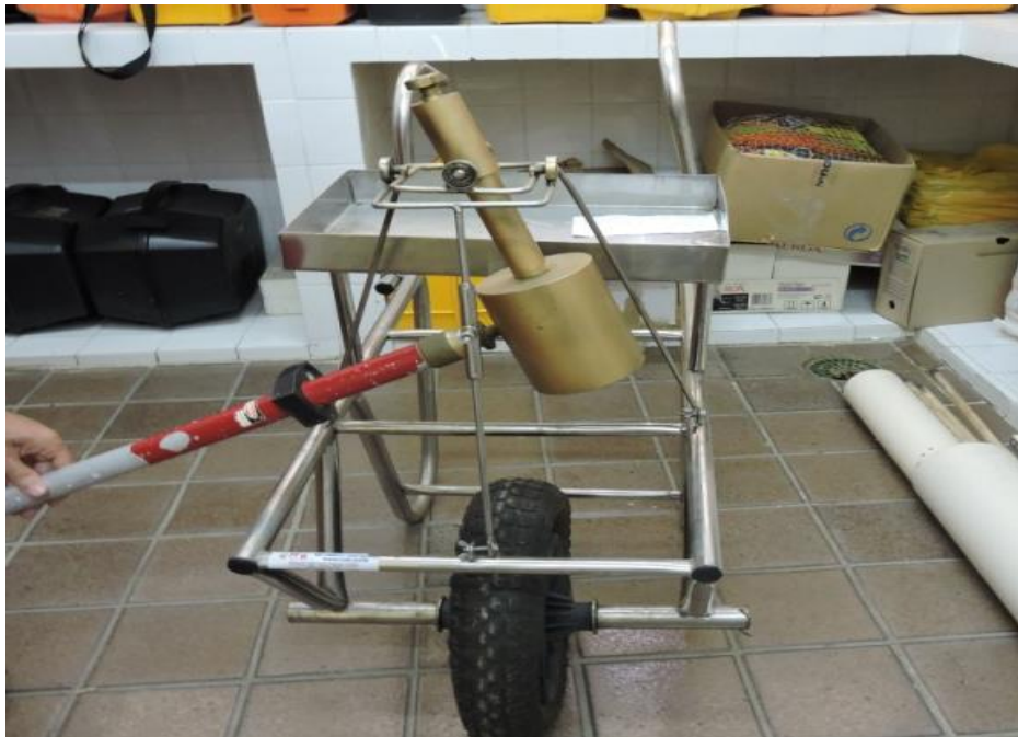
Figura 11 – Detalhe frontal do veículo transportador da antena GNSS. Fonte: Autora 2017.
