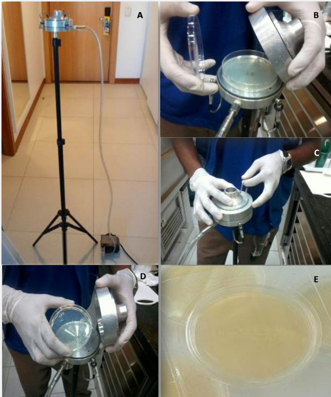
Figura 3 - Amostrador de ar do tipo Anderson® de um estágio
