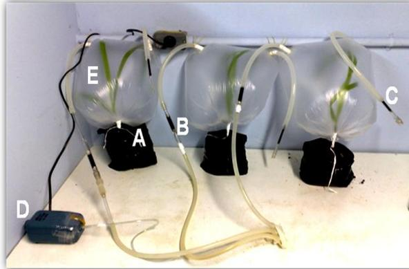
**Descrição:** (A) aponta a vedação do sistema de aeração, (B) o tubo de entrada, (C) o tubo de saída do sistema contendo carvão ativado, (D) a bomba de aquário e (E) a câmara de aeração em funcionamento.
