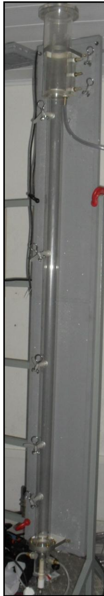
Figura 10 – Reator Anaeróbio de Leito fluidificado
