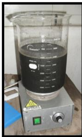
Figura 7 – Tratamento térmico do lodo proveniente de uma lagoa anaeróbia de suinocultura.
