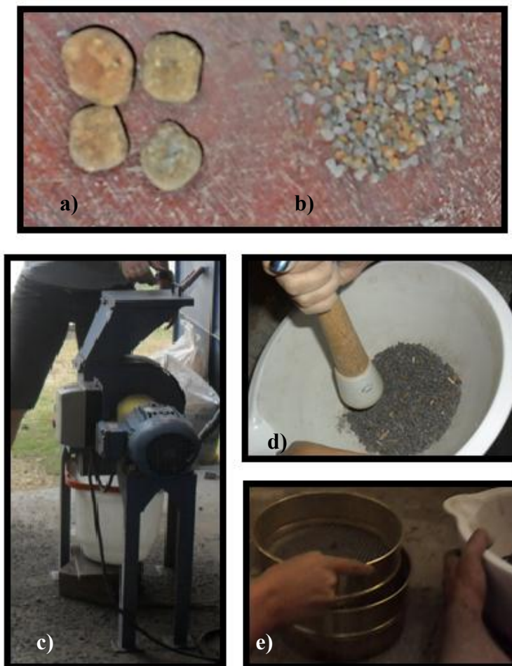
Figura 8 – a) Argila expandida adquirida como pedra para uso de jardinagem; b) Argila expandida após trituração (2,8 e 3,35 mm); c) Trituração no moinho; d) Trituração manual; e) Peneiramento.
