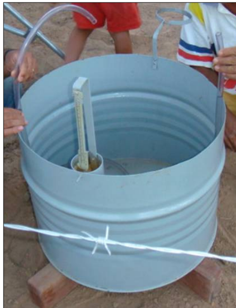
Figura 46. Foto da instalação do tanque evaporimétrico alternativo
