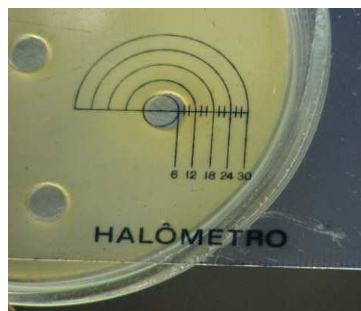
Figura 26. Halômetro, instrumento usado para medir o halo de inibição em mm.
