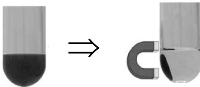
Figura 19 - Aplicação de campo magnético para separação de um catalisador magnético .
