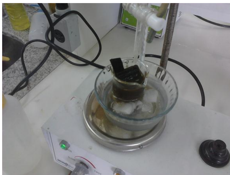
Figura 18 - Síntese das nanopartículas em presença do feltro de carbono.
