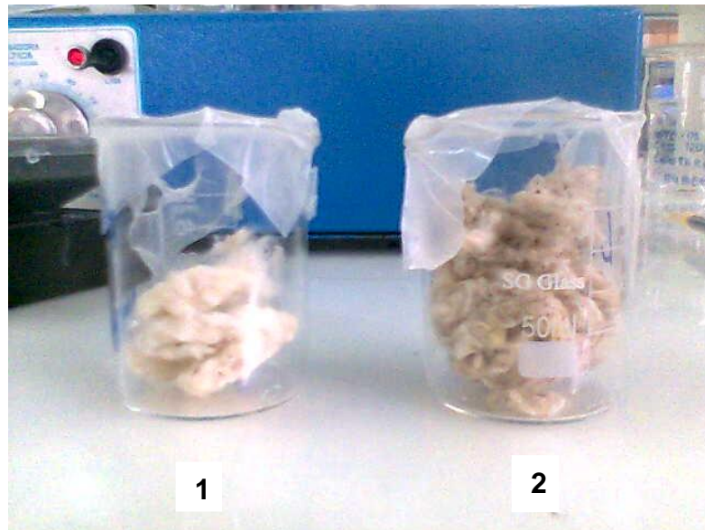
Figura 31 - Línter de algodão após tratamento com 1) NaOH e 2) água destilada.
