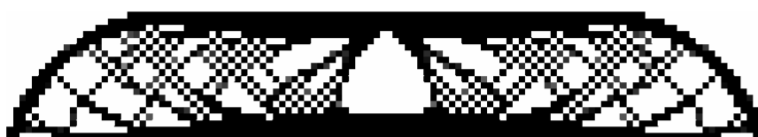
Figura 25 - Exemplo de resultado ótimo com a instabilidade numérica do padrão de tabuleiro de xadrez.
