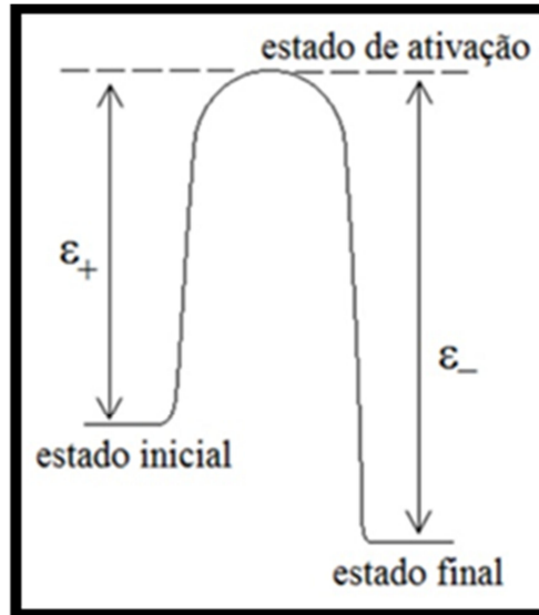
Figura 31: Representação da barreira de potencial entre os estados inicial e final. \epsilon_+ é a diferença de energia entre o estado inicial e ativado e \epsilon_- é diferença de energia entre o estado final e ativado
