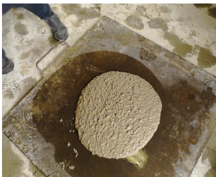
Figura 19 – Ensaio de espalhamento do concreto ótimo
