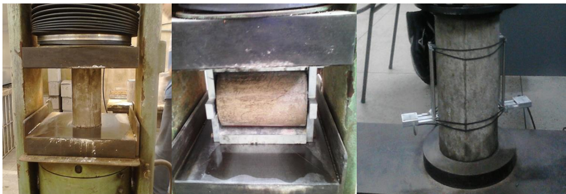
Figura 22 – Ensaio de resistência à compressão, resistência à tração e módulo de elasticidade
