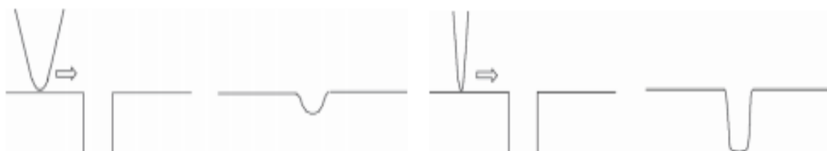
Figura 2.17: Comparação das linhas de varredura e obtidas com uma ponta de raio de curvatura maior (Esquerda) e uma sonda afiada de raio de curvatura menor (Direita) em uma amostra comum (buraco).
