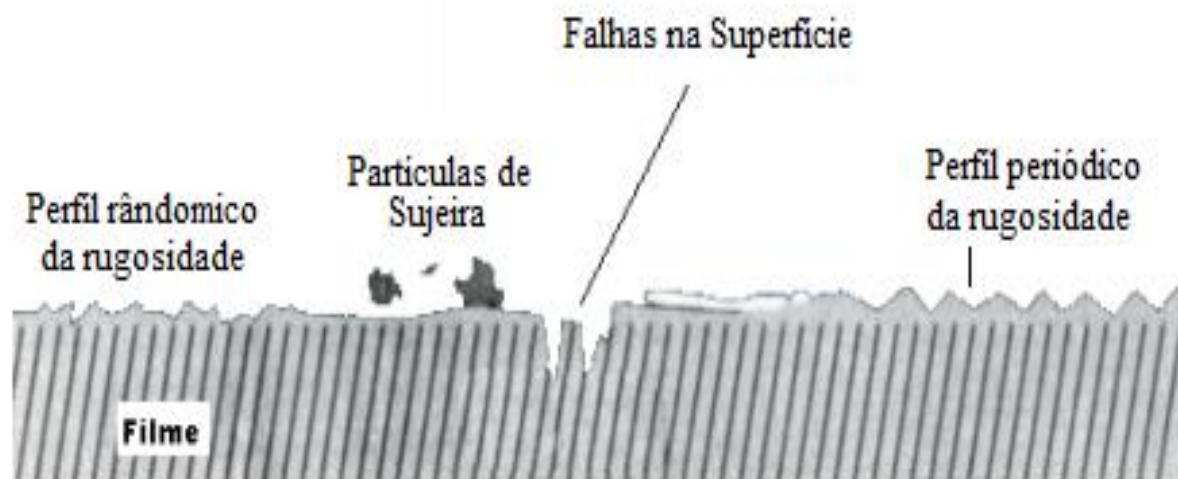
Figura 3.1: Representação de alguns fatores que podem contribuir para a rugosidade da superfície.
