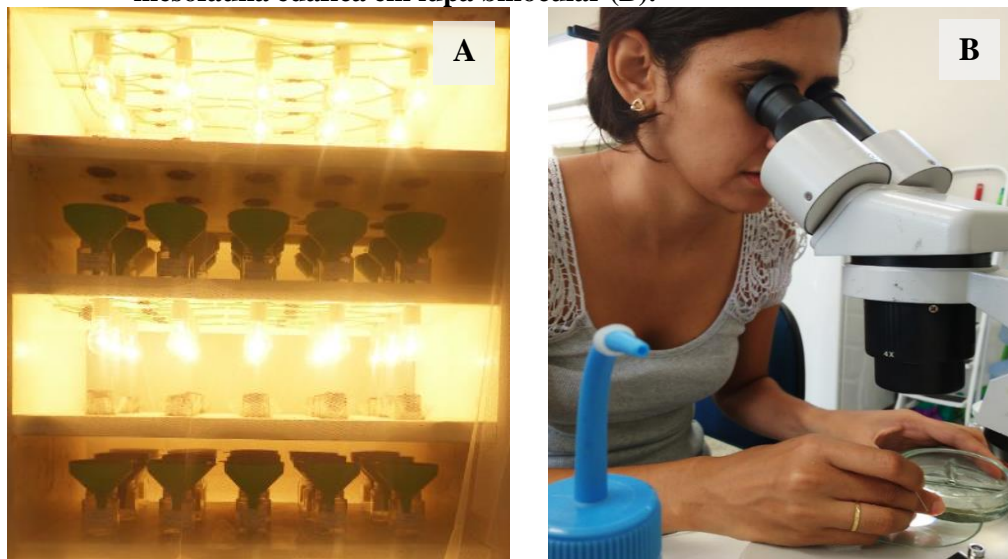
Figura 9- Bateria de extratores Berlese-Tullgren modificada para a extração de organismos do solo (A), contagem e identificação dos organismos da mesofauna edáfica em lupa binocular (B).
