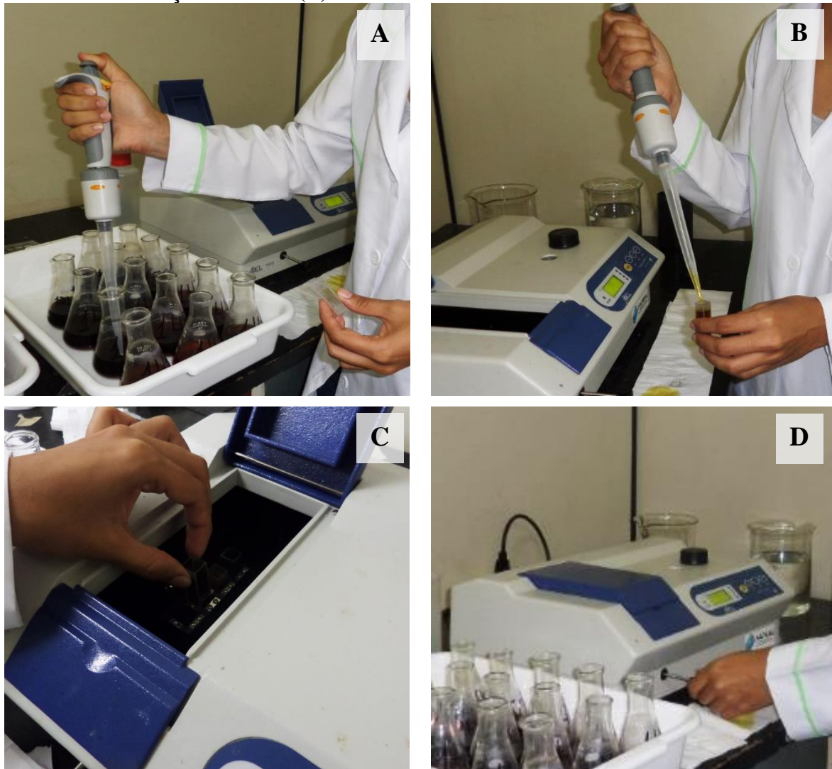
Figura 12- Transferência da solução do erlenmeyer com auxílio de pipeta graduada (A), adicionada em cubetas de vidro (B), posicionadas no espectrofotômetro (C) e realização da leitura (D).
