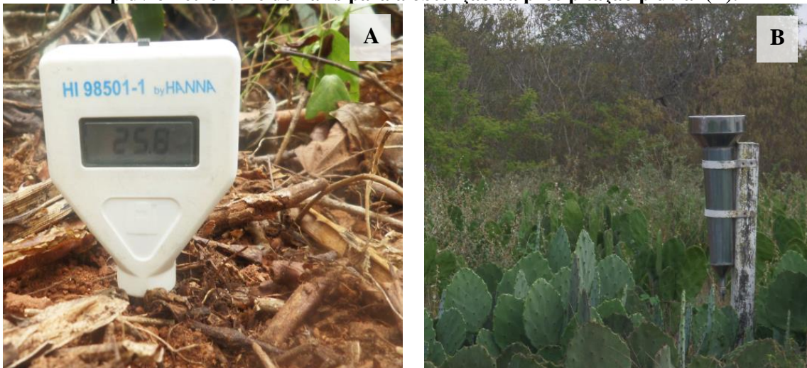
Figura 14- Termômetro digital espeto utilizado para medida de temperatura do solo (A) e pluviômetro Ville de Paris para a obtenção da precipitação pluvial (B).
