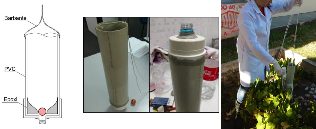
Figura 15 - a) Perfil do equipamento de coleta; b) equipamento confeccionado; c) utilização do equipamento.
