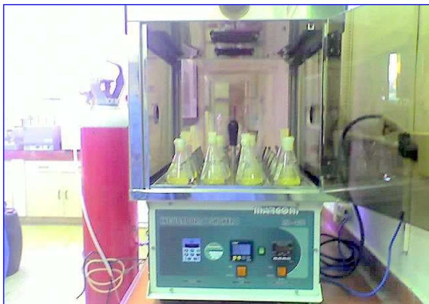
**Figura 16:** Agitador orbital contendo a suspensão quitosana e **TRF**.
