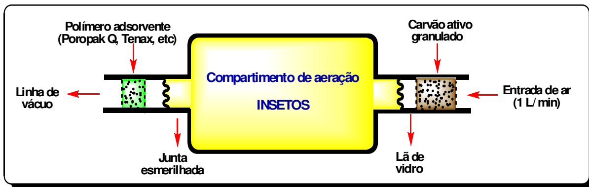
Figura 19: Sistema de aeração.
