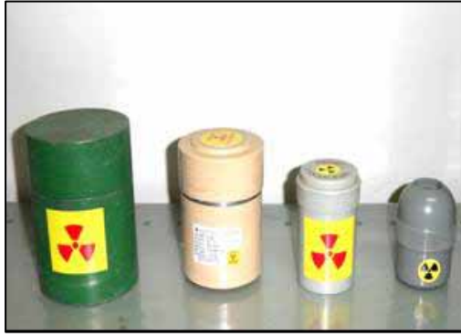
Figura 12. Castelinhos de chumbo disponíveis para transportação e conservação de fontes gama
