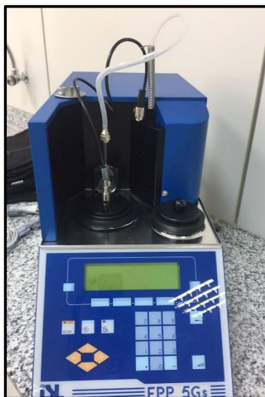
Figura 12 - Equipamento para medição do Ponto de Entupimento de Filtro à Frio modelo FCC 5Gs
