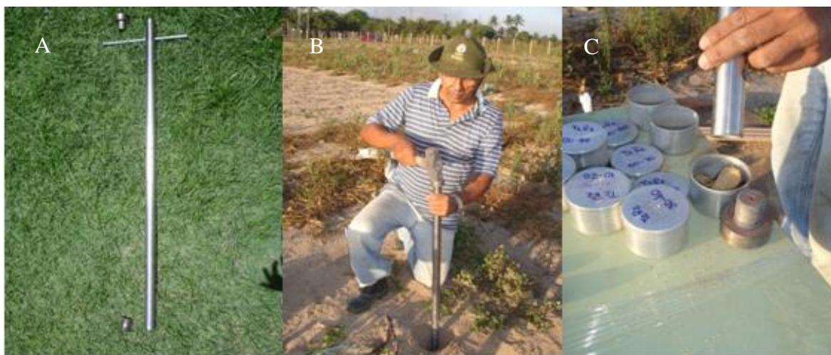
**Figura 4.** Amostragem de solo para calibração das leituras do TDR. A) sonda de coleta das amostras; B) coleta das amostras e C) acondicionamento do solo em latas de alumínio plastificadas, para envio ao laboratório.
