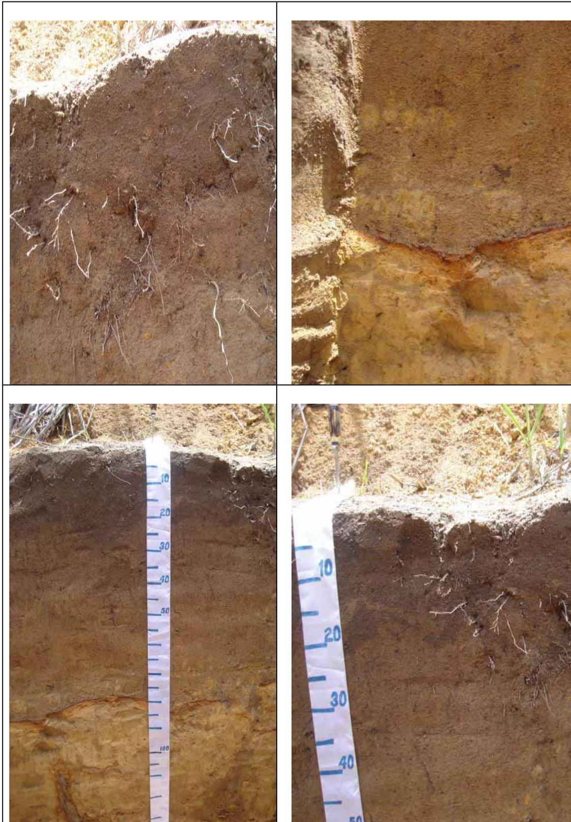
**Figura 1A.** Figura do perfil do Argissolo Amarelo Distrocoeso Fragipânico (PAdx<sub>1</sub>) – Fazenda Novo
