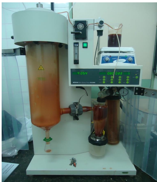
Figura 2. Atomização ( spray-drying ) das formulações a base de própolis vermelha.
