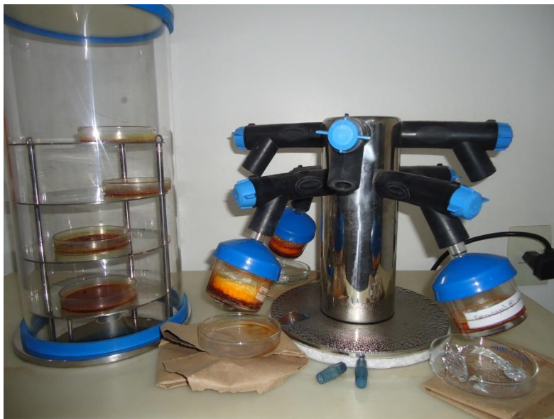
Figura 3. Liofilização das formulações a base de própolis vermelha.
