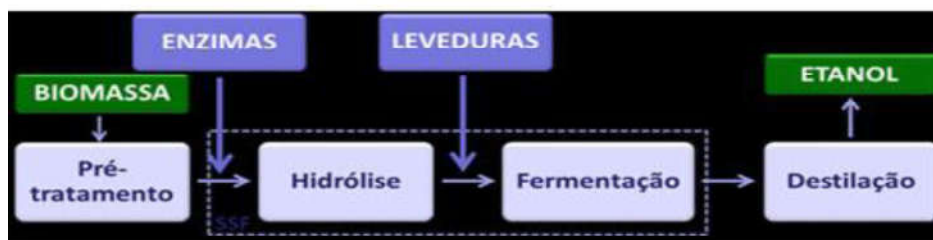
Figura 2 – Fluxo de Produção de etanol 2G
