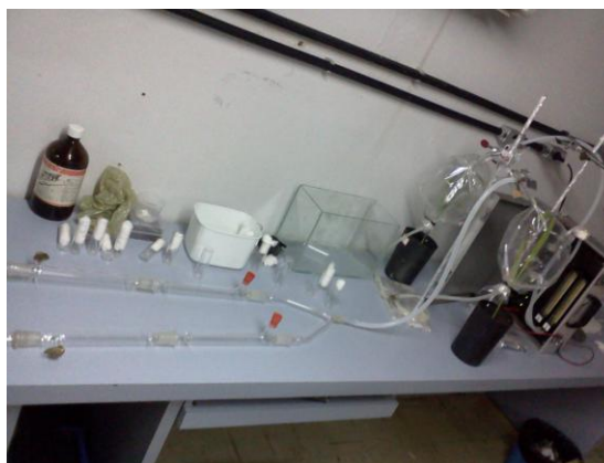
Figura 11- Bioensaio de olfatometria utilizando plantas atacadas ou não por lepidópteros no comportamento de busca de fêmeas de Cotesia flavipes . Temperatura de 24 \pm 2^{\circ}\text{C} e umidade relativa de 70 \pm 10\% .
