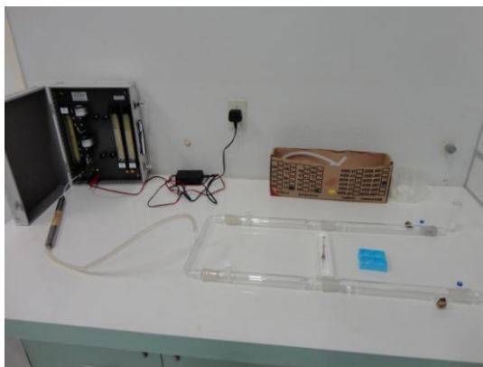
Figura 10- Bioensaio de olfatometria utilizando extratos hexânicos de plantas atacadas ou não por lepidópteros no comportamento de busca de fêmeas de Cotesia flavipes . Temperatura de 24 \pm 2^{\circ}\text{C} e umidade relativa de 70 \pm 10\% .
