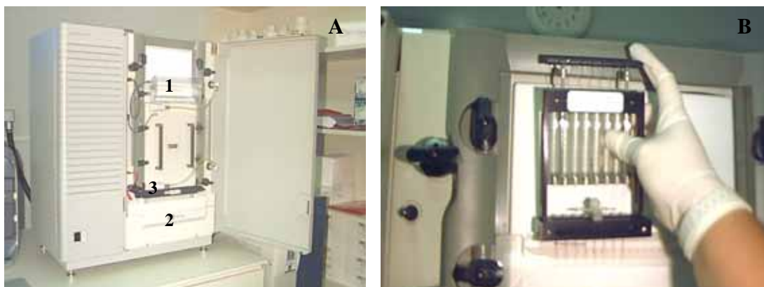
Figura 4. A) ABI PRISM 377 pronto para seqüenciamento; B) Detalhe da etapa de carregamento das amostras no gel de eletroforese no seqüenciador automático com auxílio aplicador multicanal.
