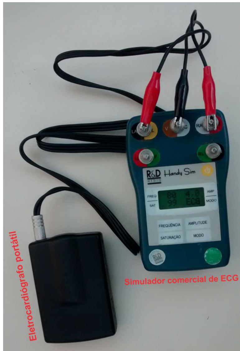
Figura 23 – Simulador de sinais de ECG acoplado a um eletrocardiógrafo portátil
