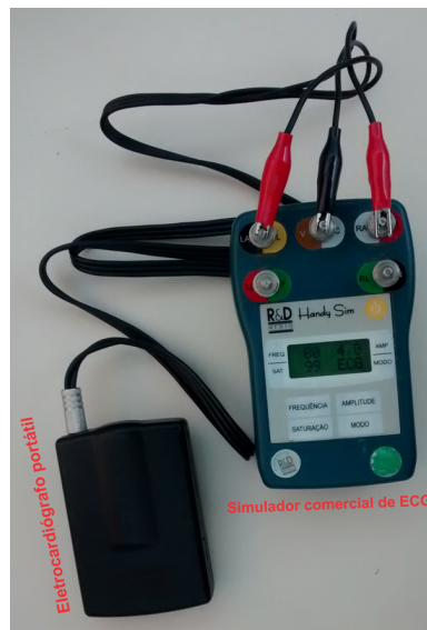
Figura 7 – Eletrocardiógrafo portátil desenvolvido por (CUNHA, 2012)
