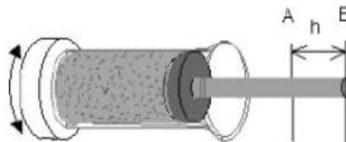
Figura 28 - Recipiente do ensaio após o processo de compressão da amostra e verificação da diferença entre a distância inicial e final do pistão.
