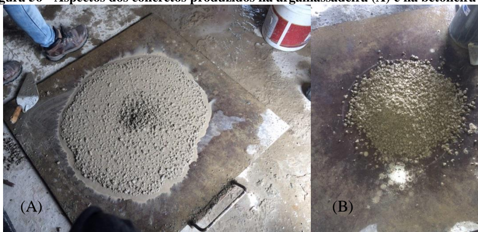
Figura 56 - Aspectos dos concretos produzidos na argamassadeira (A) e na betoneira (B).
