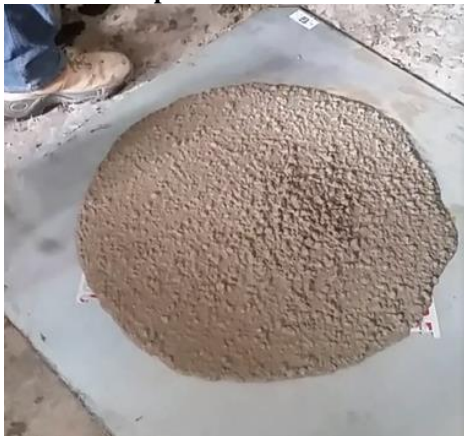
Figura 59 - Slumpflow do Concreto CARM6550.
