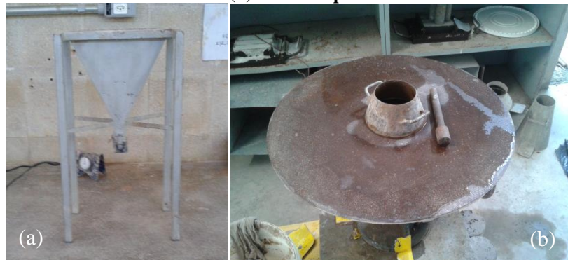
Figura 31 – Equipamentos para determinação dos parâmetros de fluidez: (a) Funil V para argamassas; (b) Minislump.
