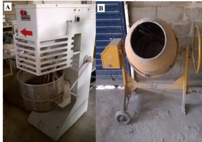
Figura 36 – Misturadores utilizados no estudo. (A) Misturador de eixo vertical e planetário; (B) misturador de eixo inclinado, betoneira.
