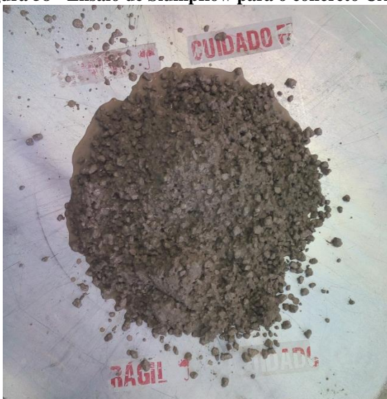
Figura 58 - Ensaio de Slumpflow para o concreto CARM
