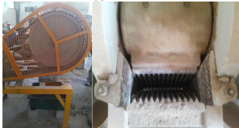
Figura 10 - Britador de Mandíbulas. (a) Vista lateral do britador, com o recipiente de coleta logo abaixo; (b) Mandíbulas.
