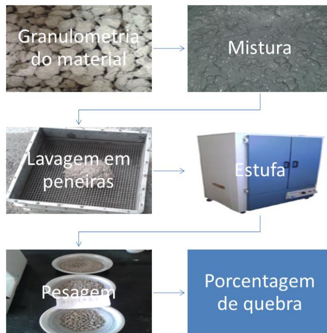
Figura 35 - Fluxograma de avaliação de quebra dos agregados.
