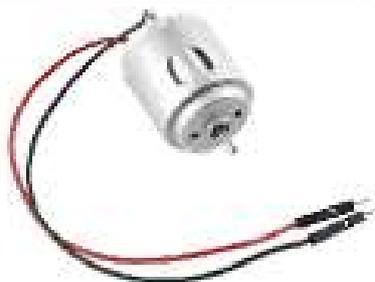
A figura acima mostra um motor de corrente contínua (DC). Não é possível ligar o motor diretamente em uma das portas da interface Arduino pois cada motor drena em torno de 500mA, enquanto que cada porta só fornece no máximo 50mA. É preciso ter um circuito amplificador de corrente para ligar qualquer motor de corrente contínua no Arduino. O exemplo da página 16 ilustra como fazer funcionar um motor DC ligado a um circuito integrado chamado ponte H que irá controlar o funcionamento do motor DC.
