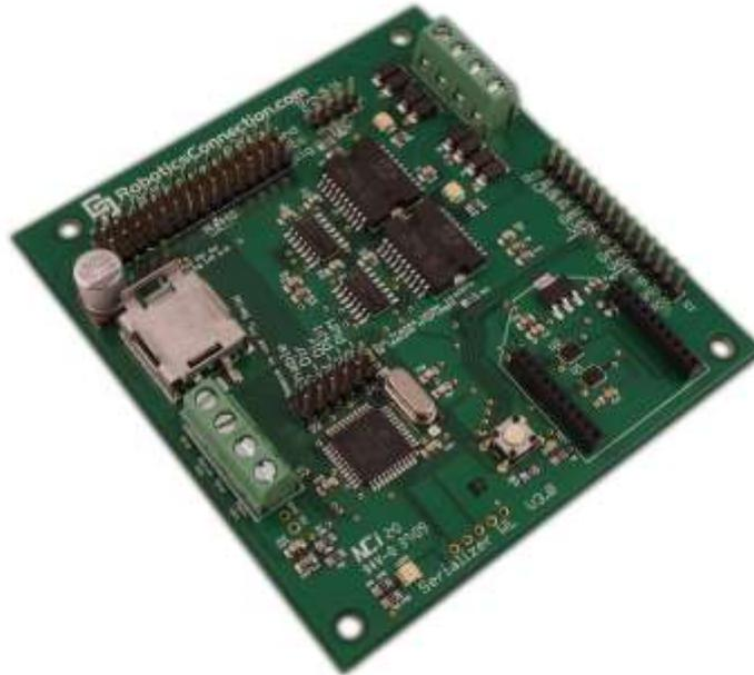
Figura 1- Interface de controle para robôs com várias portas de I/O
