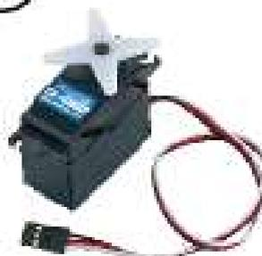
A figura acima mostra o servo motor e seus conectores. O fio preto deve ser ligado ao terra (GND), o fio vermelho ao positivo (5v) e o fio amarelo ou branco a qualquer porta PWM do Arduino. Para usar este tipo de motor é necessário fazer uma chamada a biblioteca `servo.h` que se encontra na pasta do Arduino. O exemplo de código a seguir mostra como movimentar um servo motor de posição.
