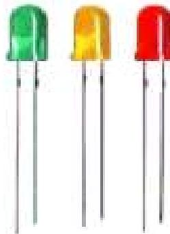
O diodo emissor de luz ou LED (Light Emission Diode) é um componente eletrônico dos mais comuns e úteis para emitir luz em várias cores e intensidades. É um componente de fácil aquisição, barato e que economiza muita energia. Porém, devemos tomar alguns cuidados ao utilizar um LED:
