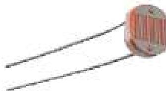
A figura acima mostra um sensor de luz do tipo LDR (light Dependent Resistor), ou resistor variável dependente de luz, que deve ser usado geralmente em pares para criar, por exemplo, um robô seguidor de linha. Este sensor deve ser soldado a dois fios ou ligado na matriz de contatos e ligado a qualquer porta analógica do Arduino. O exemplo de código a seguir mostra como usar o LDR como sensor de luz.
