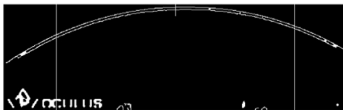
Figura 18 – Exemplos de duas imagens com segmentação de bordas e com a delimitação dos 400 pixels centrais.
