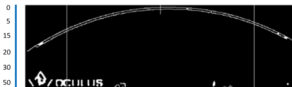
Figura 19 – Imagem segmentada com um eixo exemplificando que quando mais próximo da parte mais superior da imagem o ponto estará em uma posição mais próxima de 0 e quando mais afastada mais distante.
