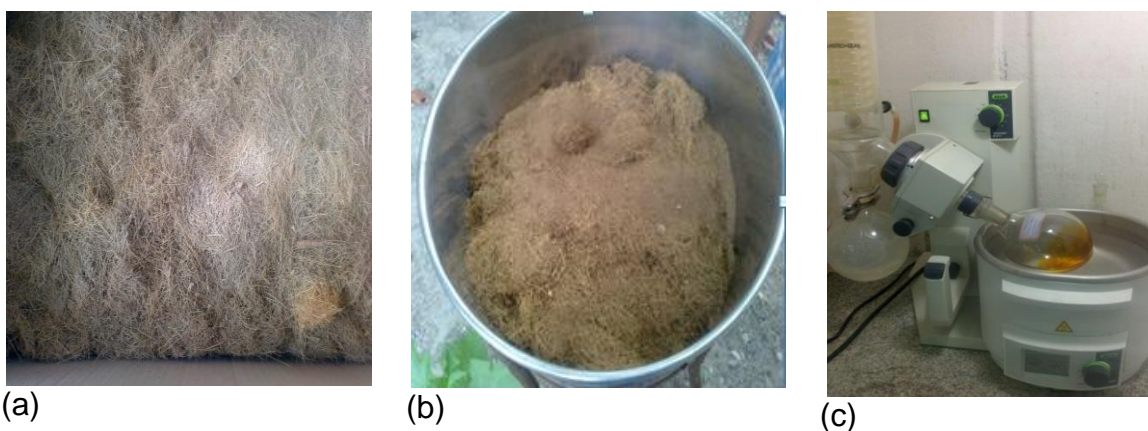
Figura 4 - Pó da fibra de casca de coco (a), Pó da fibra em percolador (b) e concentração do extrato em rotaevaporador (c).
