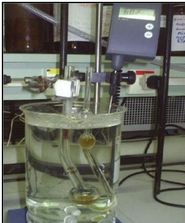
Figura 7 – Sistema para determinação da viscosidade cinemática (SILVA, 2008).
