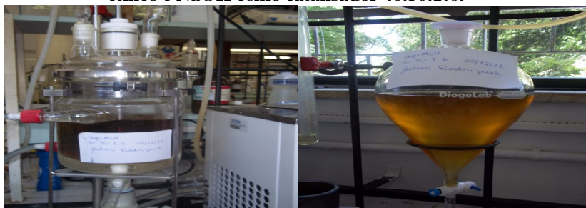
Figura 21 - Reação 12 de transesterificação de óleo de soja com álcool etílico e NaOH como catalisador 40.30.1:6.
