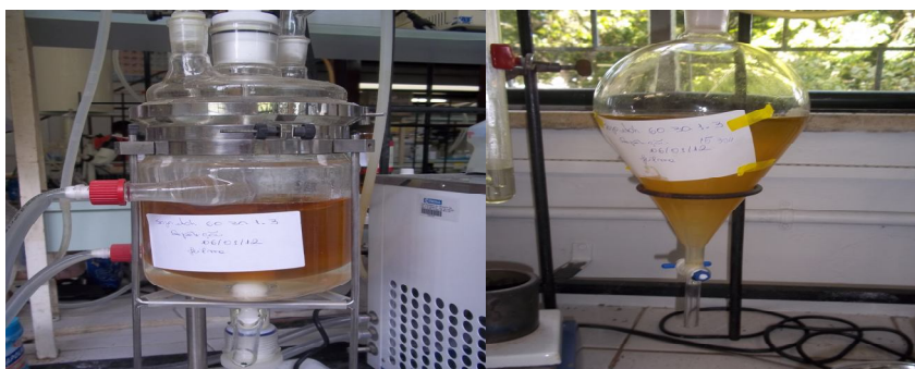
Figura 22 - Reação 15 de transesterificação de óleo de soja com álcool etílico e NaOH como catalisador 60.30.1:3.
