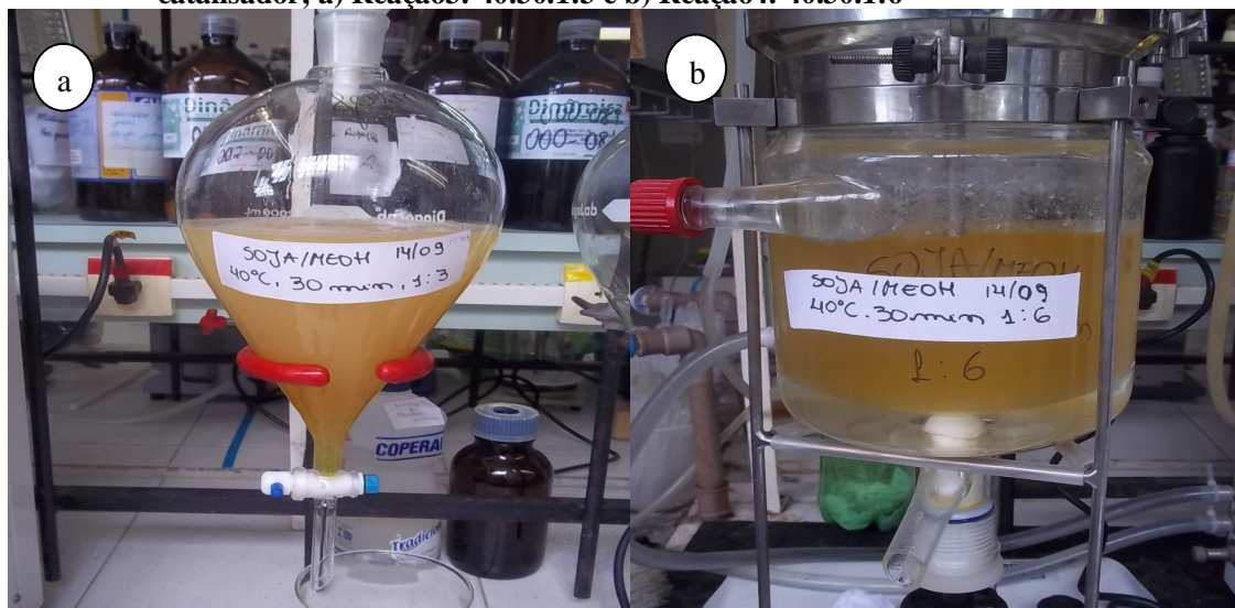
Figura 18 - Reações de transesterificação de óleo de soja com álcool metílico e NaOH como catalisador; a) Reação3: 40.30.1:3 e b) Reação4: 40.30.1:6
