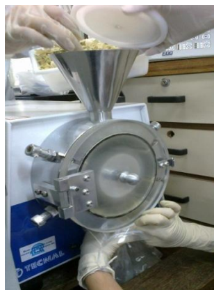
Figura 13 - Palha sendo cominuída em um moinho de facas.
