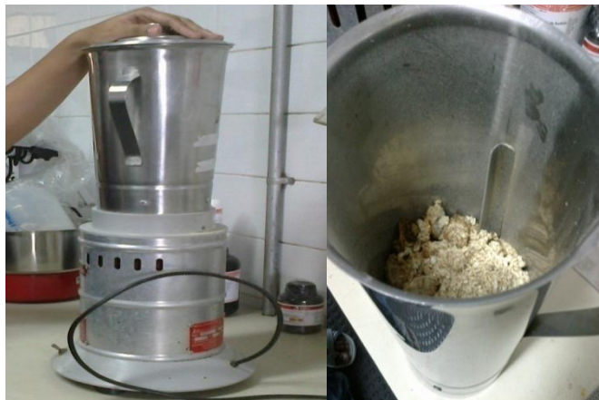
Figura 12 - Sabugo sendo triturado em liquidificador industrial.
