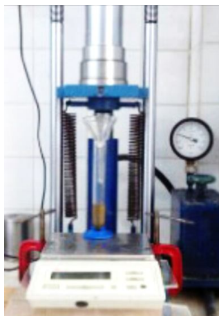
Figura 8 – Extração mecânica em prensa hidráulica
