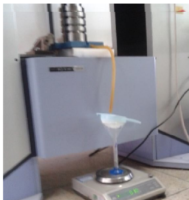
Figura 9 - Extração mecânica na prensa elétrica
