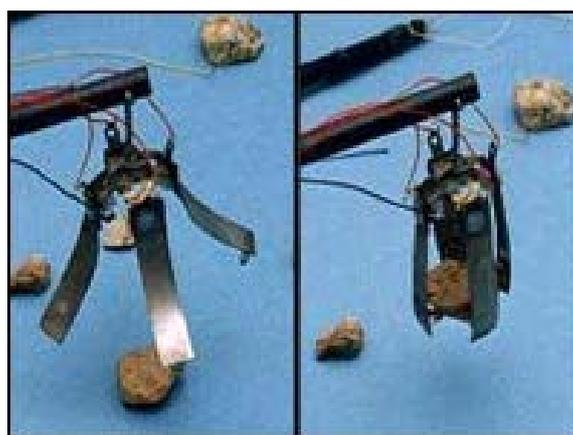
**Figura 10.** Exemplo de um dispositivo que responde com um movimento mecânico quando se aplica uma diferença de potencial.
