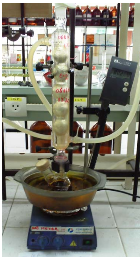
Figura 4.1. Sistema reacional utilizado para a preparação de todos os colóides apresentados neste trabalho.
