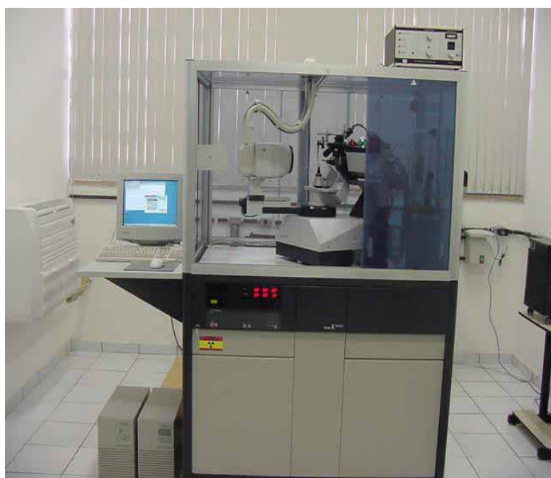
Figura 36 - Vista do difratômetro automático KappaCCD do laboratório de cristalografia e modelagem molecular do IQB-UFAL.
