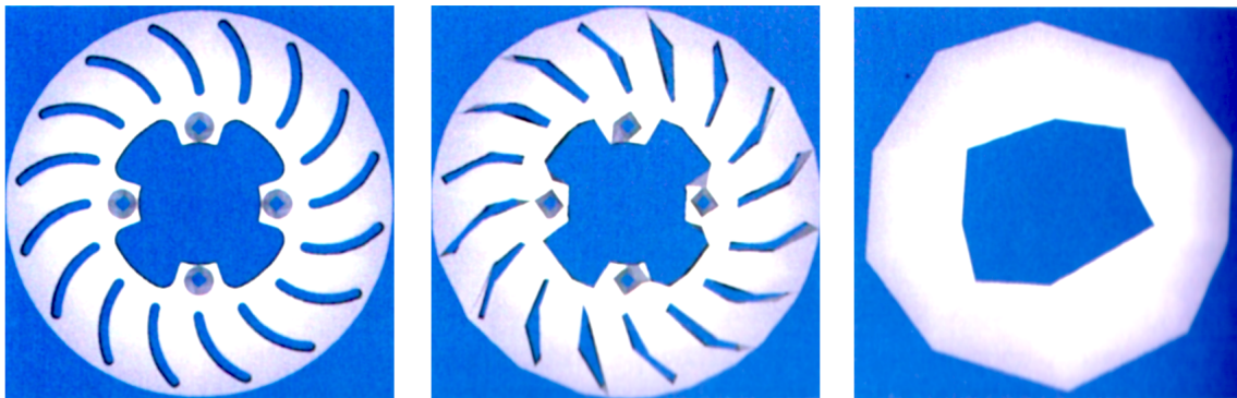
(a) 4736 triângulos e 21 buracos. (b) 1006 triângulos e 21 buracos. (c) 46 triângulos e 1 buraco.
