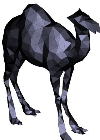
(b) Malha simplificada com 1128 triângulos, DI, r=0.05
